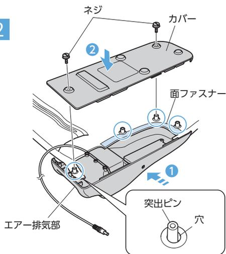
① 三次元ファイバーの穴とマットの穴4箇所、エア－排気部の突出ピンを通し、面ファスナーで貼り付ける。
