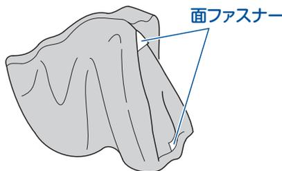
内カバー底面前後の面ファスナーを本体底面の面ファスナーに合わせながら内カバーを本体に入れ、取付けファスナーを付けてください。
