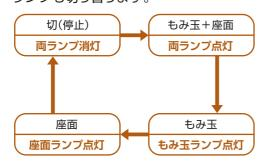
●もみ玉が停止中に「ヒーター」ボタンを押すと、座面ランプのみが点灯します。 「ヒーター」ボタンを押すたびに、下記のようにヒーターの動作が切り替わり、表示ランプも切り替ります。
