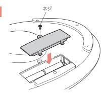
電池カバーを取り付け、ネジを 締めてください
