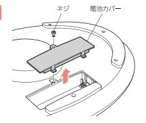
お手持ちの⊕ドライバー(O番)で ネジを外し、電池カバーを取外し てください
